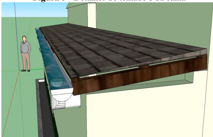
Figura 5 - Detalhes do telhado e da calha
